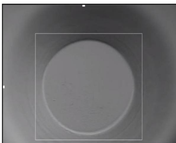
Figure 20.37 Exemple de position correcte d'un puits dans l'écran de visualisation de la caméra
